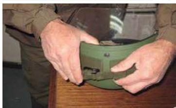
Posteriormente deberá ajustarse al casco, por medio del sistema dentado, de material plástico que posee en la parte posterior.
